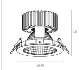
Diamètre | 140mm Découpe | 130mm Largeur collerette | 20mm Hauteur | 111mm Plénum | 171mm Poids | 0,7Kg Distance de sécurité | 500mm
